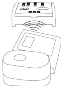
Encoche pour IR transmission de données
