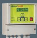
Jedem Sensor der **descon®trol M** Geräte sind zwei Grenzwerte zugeordnet, die separate Relais schalten. Hierüber kann ein akustisches Signal ausgelöst werden, bzw. über den 2. Grenzwert wird eine Berieselungs-Anlage aktiviert. Messbereiche im ppm-Bereich, je nach Sensor, mit automatischem Sensoren-Test, Testzyklus einstellbar. Anzeige über zweizeiliges LCD - Display, Menüführung mit Statusmeldungen im Klartext, sowie Anzeige der Betriebszustände.
